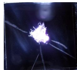
過飽和の蒸気は冷やされている容器の底に薄く広がっているだけなので、底に平行に走った放射線しか見ることができません。また液体の粒はすぐ蒸発してしまって、数秒で見えなくなってしまいます。
